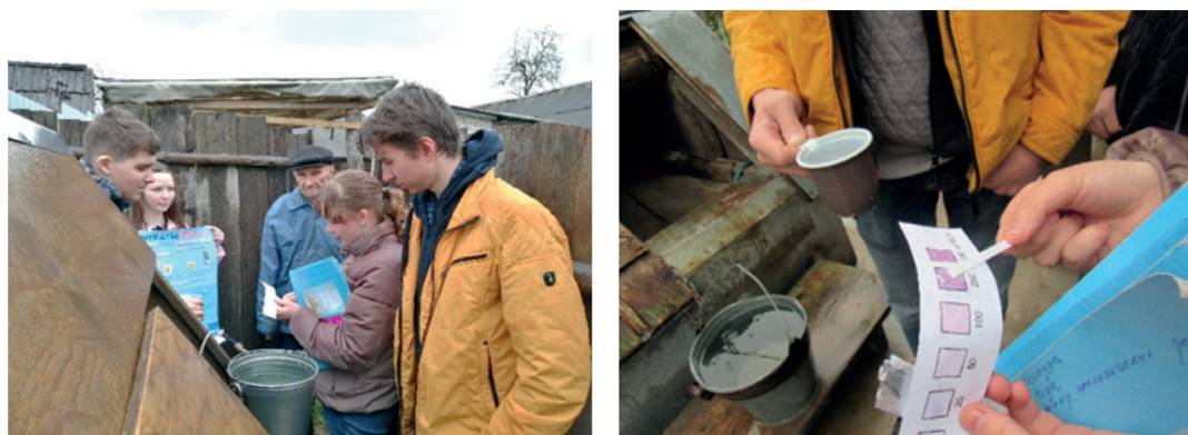
Рис. 1. Исследования колодезной воды на содержание нитратов экспресс-методом с использованием тест-полосок Merckoquant® Nitrate Test
